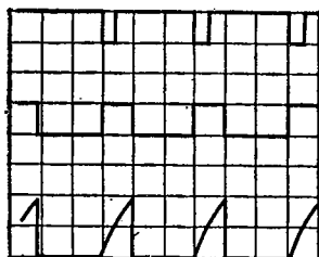
Рис. 2. Форма напряжений в режиме од- новибратора. U_{КК}=5 В, время=0,1 мс/дел., R_A=9,1 кОм, C = 0,01 мкФ, верхняя кривая: вход 5 В/дел., средняя кривая: выход 5 В/дел., нижняя кривая: напряжение на конденса- торе 2 В/дел.
